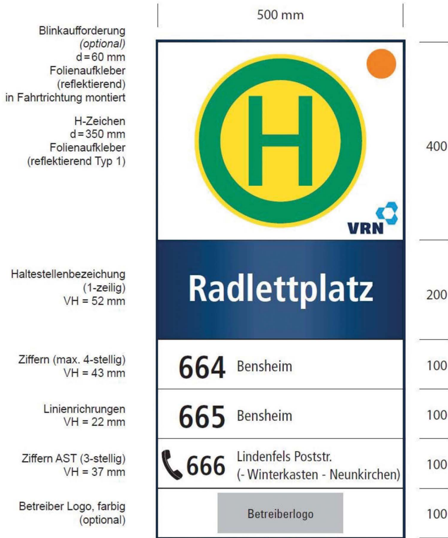
Abbildung 50: Wechselschildsystem mit gewölbter Oberfläche (höherwertiges System)
